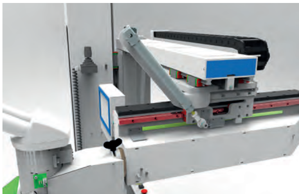
Abbildung 66 – Führungsschiene der Y-Achse
