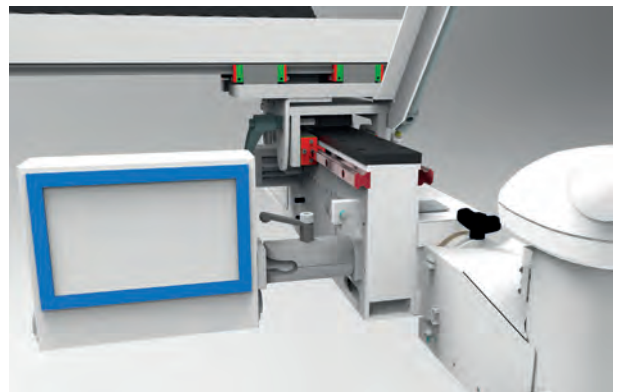
Abbildung 67 – Führungsschiene der Y-Achse
