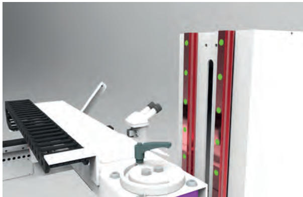
Abbildung 68 – Lineare Führungsschienen auf der Z-Achse
