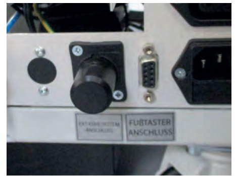
Abbildung 16 – Verriegelungs- und Fußtasteranschluss
