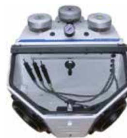
Sabbiatrice fina da tavolo joke microjet 3 , cabina con 3 contenitori di abrasivo
