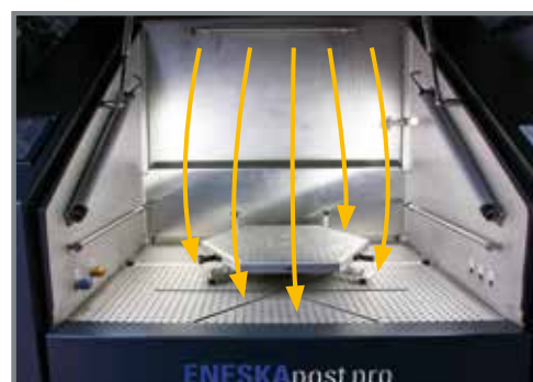
Grazie ad una conduzione ottimizzata del flusso dell'aria, le polveri pericolose sono portate in direzione di aspirazione.
