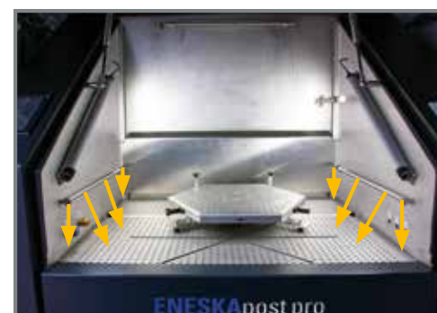
Dopo la fase di lavorazione, l'impianto può essere aperto solo a conclusione di uno speciale processo di pulizia automatico, durante il quale i residui di polvere depositatisi negli angoli del vano sono alzati ed aspirati.
