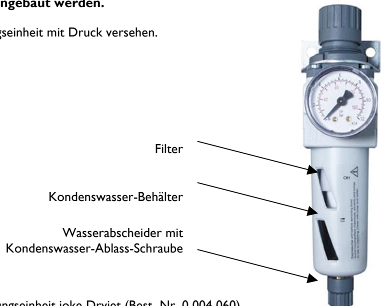
Bild 9.1 Wartungseinheit joke Dryjet (Best.-Nr. 0 004 060)
