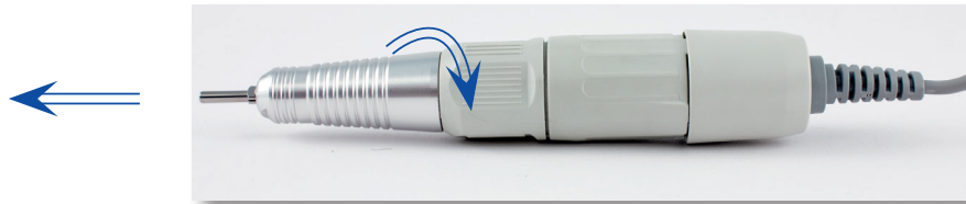
Bild 7.4 Werkzeugwechsel beim Handstück
