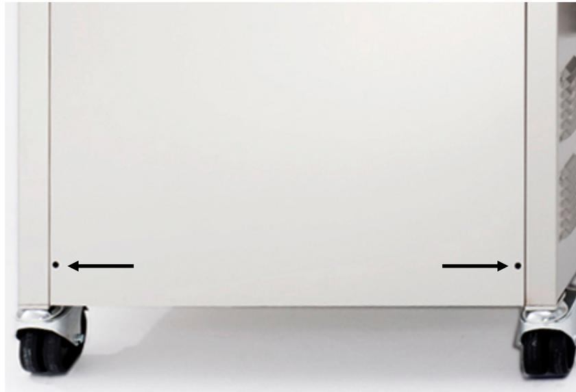
Abb.9.5.1. Position der 2 Inbusschrauben
