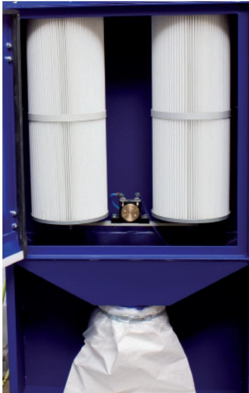
Bild 10. 1 geöffnetes Filtergehäuse
