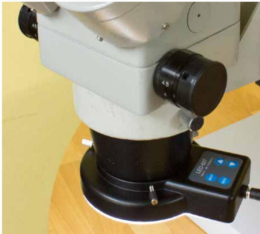
Utilizzo della lampada LED ad anello con accensione a segmenti sullo stereomicroscopio SM-200
