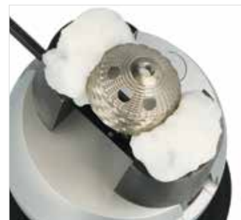
Ganasce da formare in granulato da modellare
