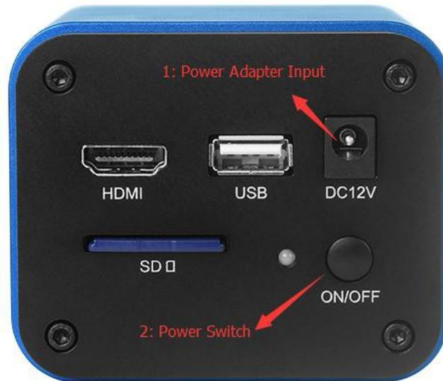
Um die Kamera einzuschalten, stecken Sie bitte zuerst das Netzteil in den DC12V-Anschluss (siehe Bild oben). Die LED auf der Rückseite leuchtet dann rot auf. Um die Kamera in den Arbeitsmodus zu versetzen, drücken Sie bitte einmal die On/Off (Ein-/Aus)-Taste. Die LED wechselt jetzt von rot auf blau. Die blaue LED zeigt an, dass die Kamera nun betriebsbereit ist.
