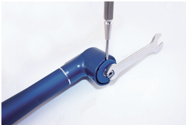
Figure 7.5 changement de pince de serrage
